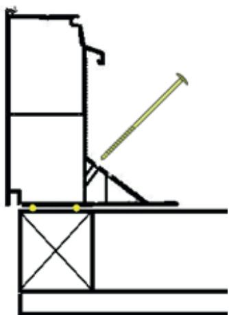
**NL** Plak de opstand in volgens de richtlijnen zoals deze gesteld zijn door BDA. Zorg voor een deugdelijke montage, door bij de bevestiging om de 30 cm op de regels en de raveling te schroeven. Gebruik schroef 8,0 x 80 in de bovenste ril van de opstand.
